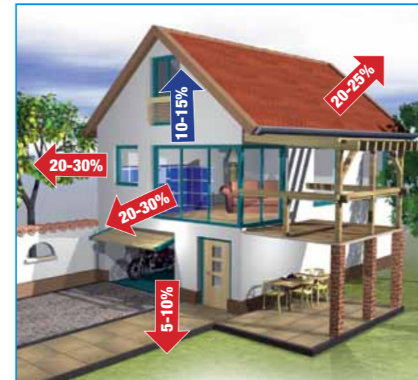
Egy épület hővesztésének százalékos megoszlása egy-egy épületszerkezeten
