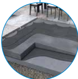
Talajon fekvő terasz rétegrénd
