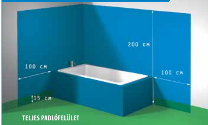
Vízszigetelés fürdőkád beépítése esetén
