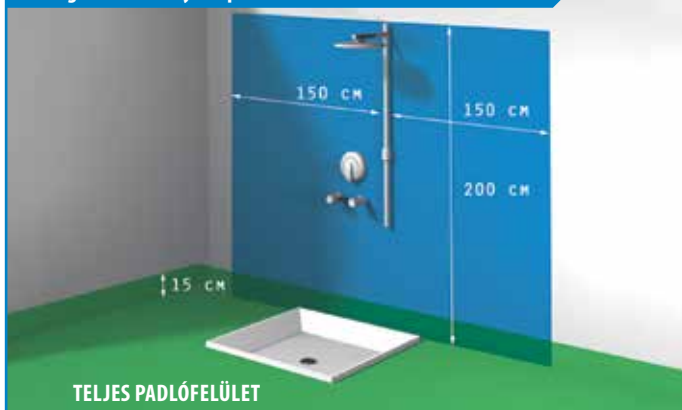
Vízszigetelés zuhany beépítése esetén
