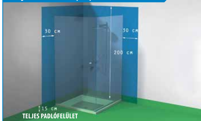
Vízszigetelés hátfalas zuhany beépítése esetén
