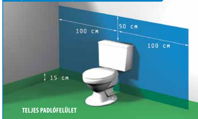
Vízszigetelés WC / bidé beépítése esetén
