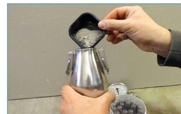
A porított minta beöntése a tartályba, majd acélgolyók és üvegampulla hozzáadása.
