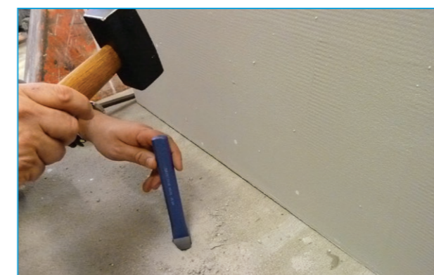
Mintavétel az aljzathoz, a vizsgálandó anyag összegyűjtése, porítása, majd tömegmérése
