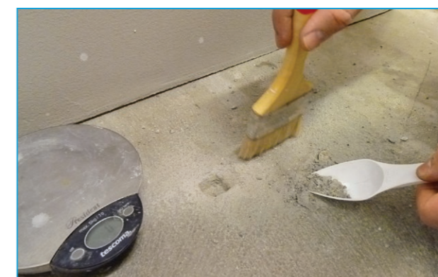
Mintavétel az aljzathoz, a vizsgálandó anyag összegyűjtése, porítása, majd tömegmérése
