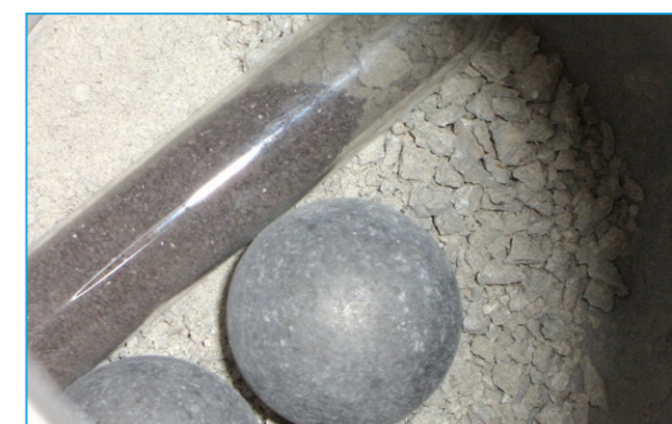
A porított minta beöntése a tartályba, majd acélgolyók és üvegampulla hozzáadása.
